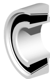
3D (ころが黒で強調表示されている断面と、保持器)
