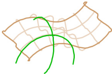
既存の NURBS 曲面上の点をクリックし、 曲率円を作成 を選択してその点に曲線を配置します。
